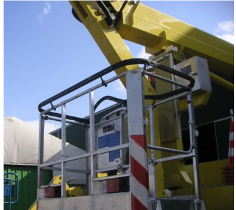
Bild 6-4 Absicherung von Bedienpult und Geländer durch eine Abschaltleiste gegen Quetschgefahren
